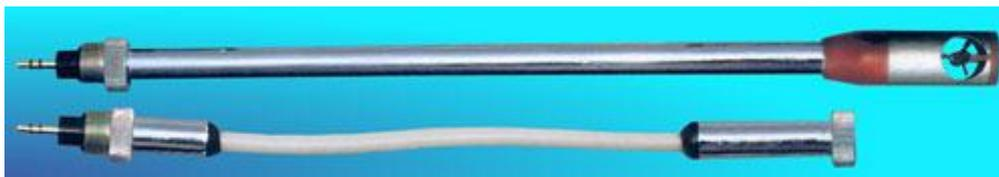
Коллектив авторов-разработчиков анемометра АПР-2 продолжает работу над расширением его функциональных возможностей. Разработан и успешно прошёл промышленные испытания, работающий в комплекте с анемометром АПР-2, измерительный преобразователь типа Т-1 (диаметр 17 мм, длина 300 мм) для измерения скорости в диапазоне от 0,4 до 60 м/с в дегазационных трубопроводах, а также и во многих других случаях.
